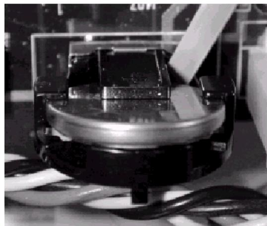
4. 새로운 리튬 전지를 긍성(+)을 확인하여 배터리 홀더에 넣으시기 바랍니다.
